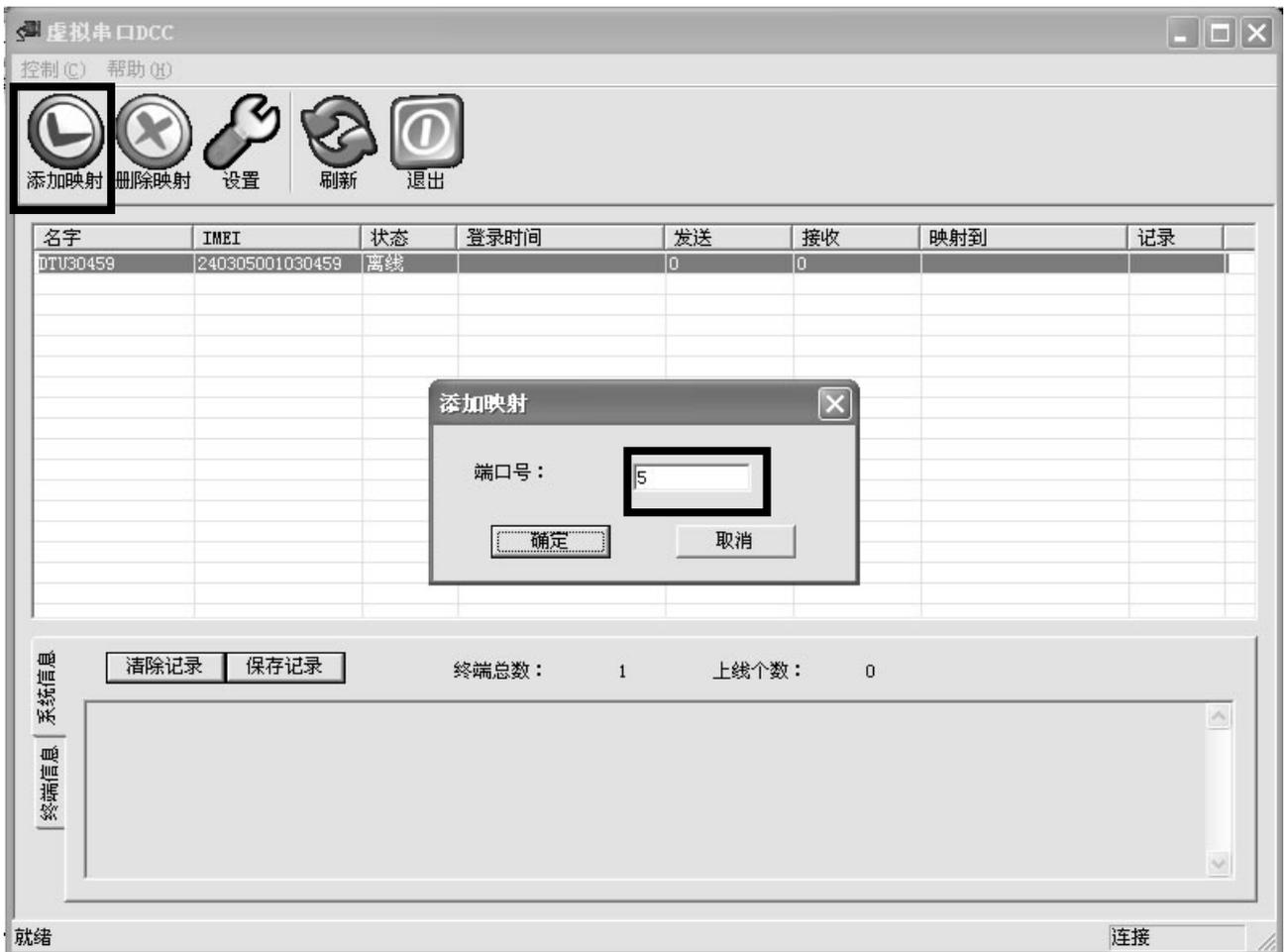
**步骤 6.** 映射成功之后，本地用户端控制程序即可以通过打开 Vircom 虚拟出的串口 5 来实现对远程用户设备的数据采集和控制。
