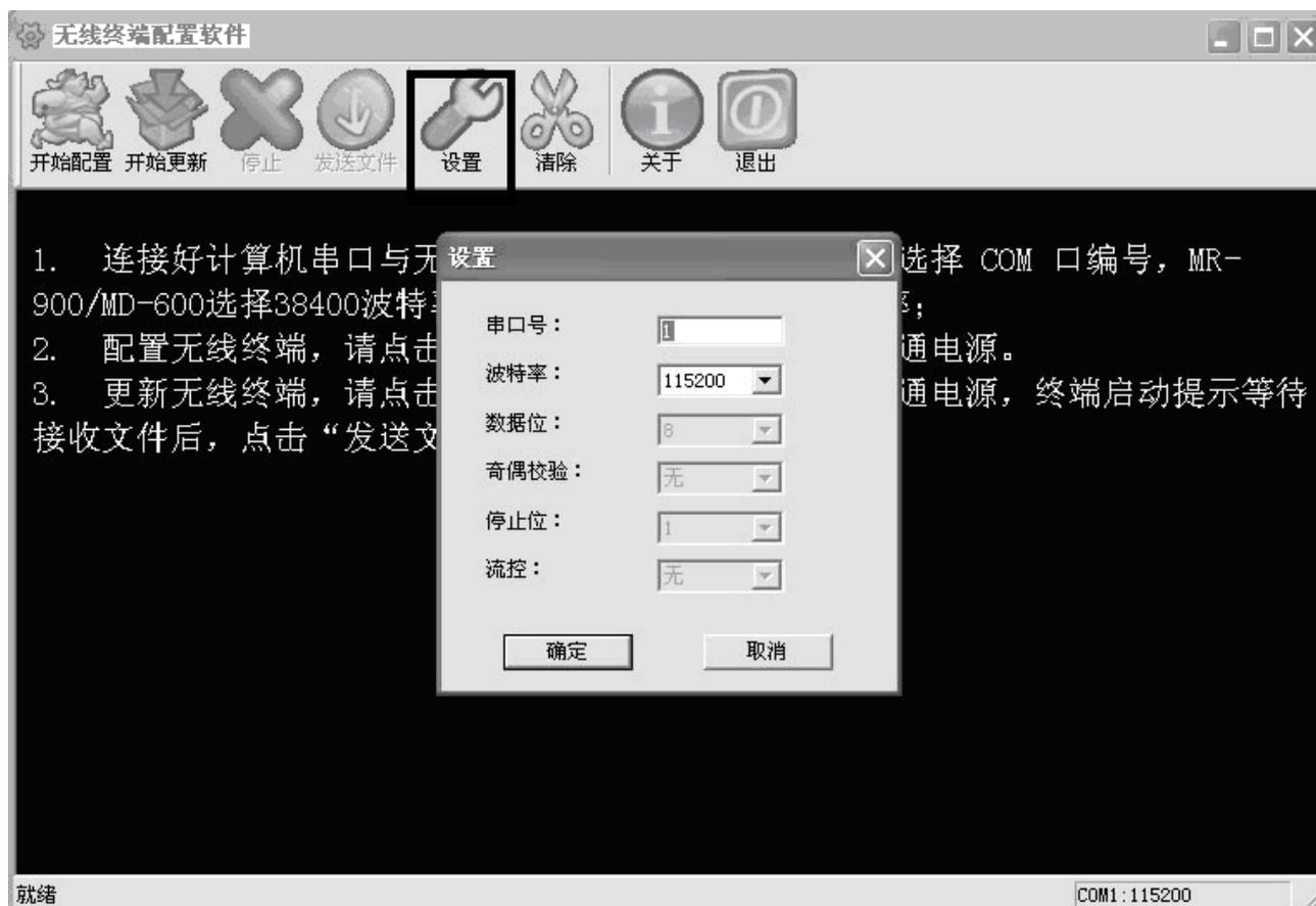
步骤 4. 按软件界面提示点击“开始配置”, 并在 30 秒内迅速接通 MD69G 电源
