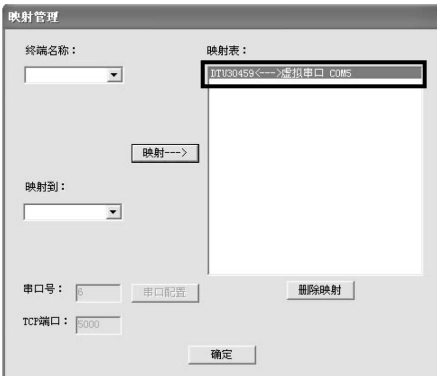
**步骤 3.** 单击“确定”，虚拟串口即映射成功，在 mServer 界面的“映射到”栏目中会有相应标识：
