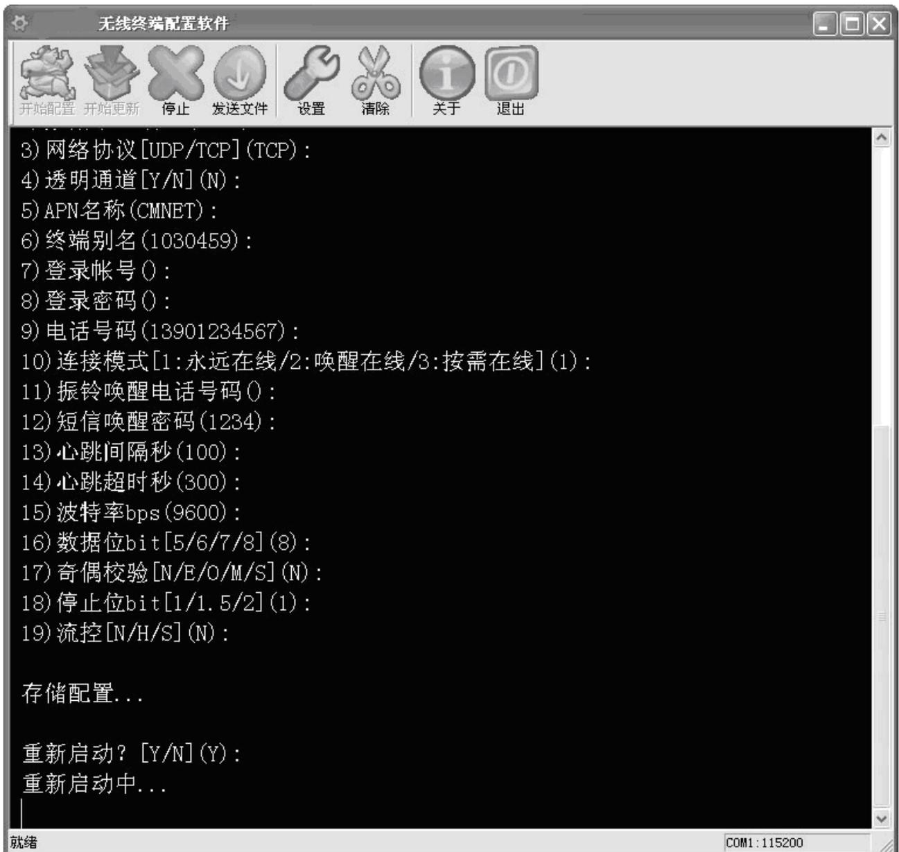
注意：1. 在实际应用中，MD69G 通过串口线连接用户设备，需要在此配置过程中设置串口属性（该配置选项部分在上图中已用白框框出）以方便与用户设备串口匹配；
