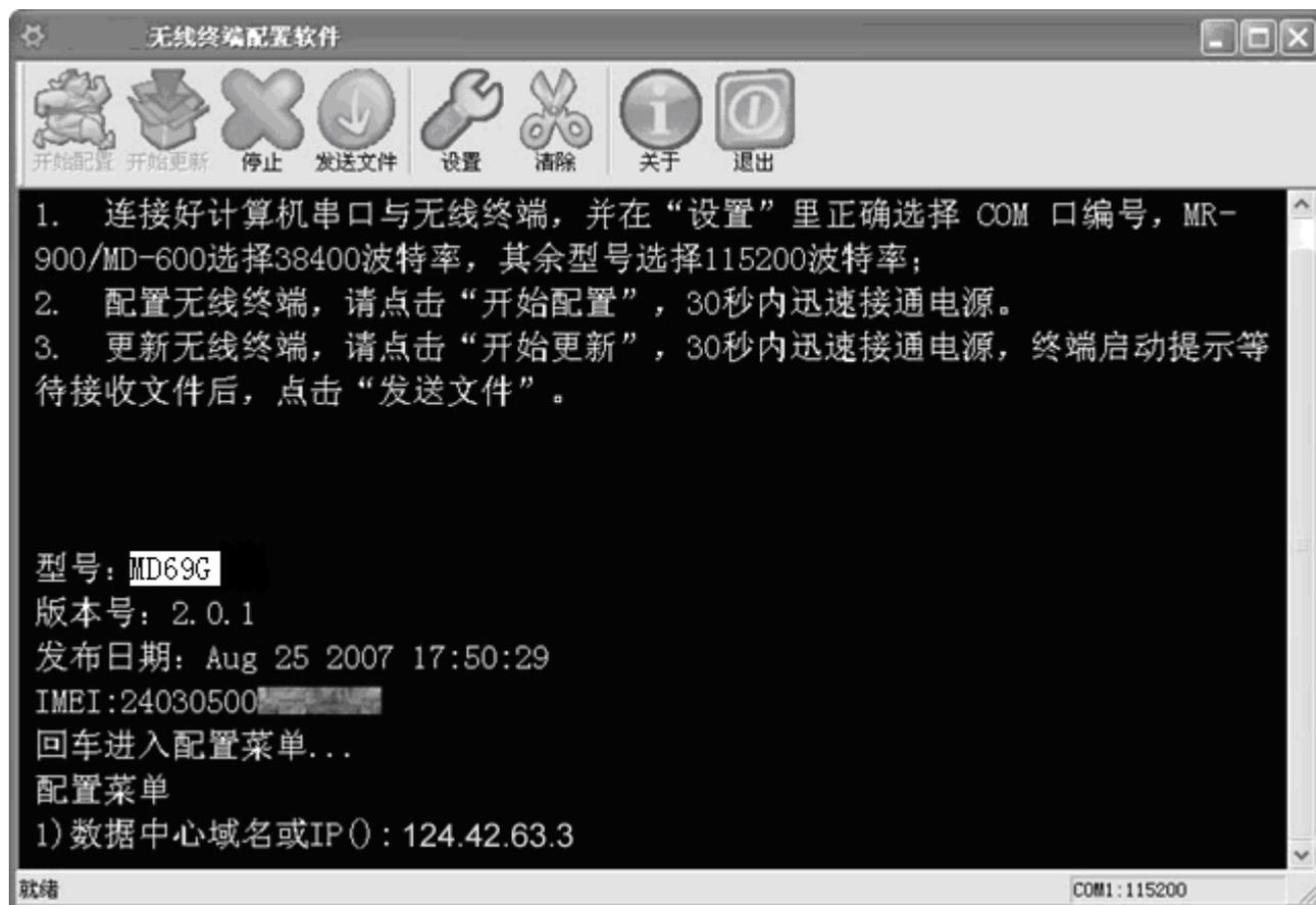
**步骤 6.** 敲击回车键，在出现的第二个配置项“**2) 数据中心端口(9000)**”中输入 mServer 监听的端口“9000”（也可直接敲击回车键以保留括号内的默认值“9000”），之后，连续敲击回车键直到出现提示“重新启动中”，MD69G 即已配置完毕：
