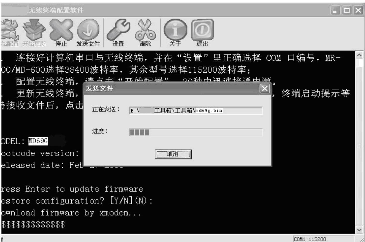
**步骤 6.** 固件更新完毕后会提示设置重启，断开 MD69G 电源及其与电脑的连接即可，MD69G 固件更新成功：
