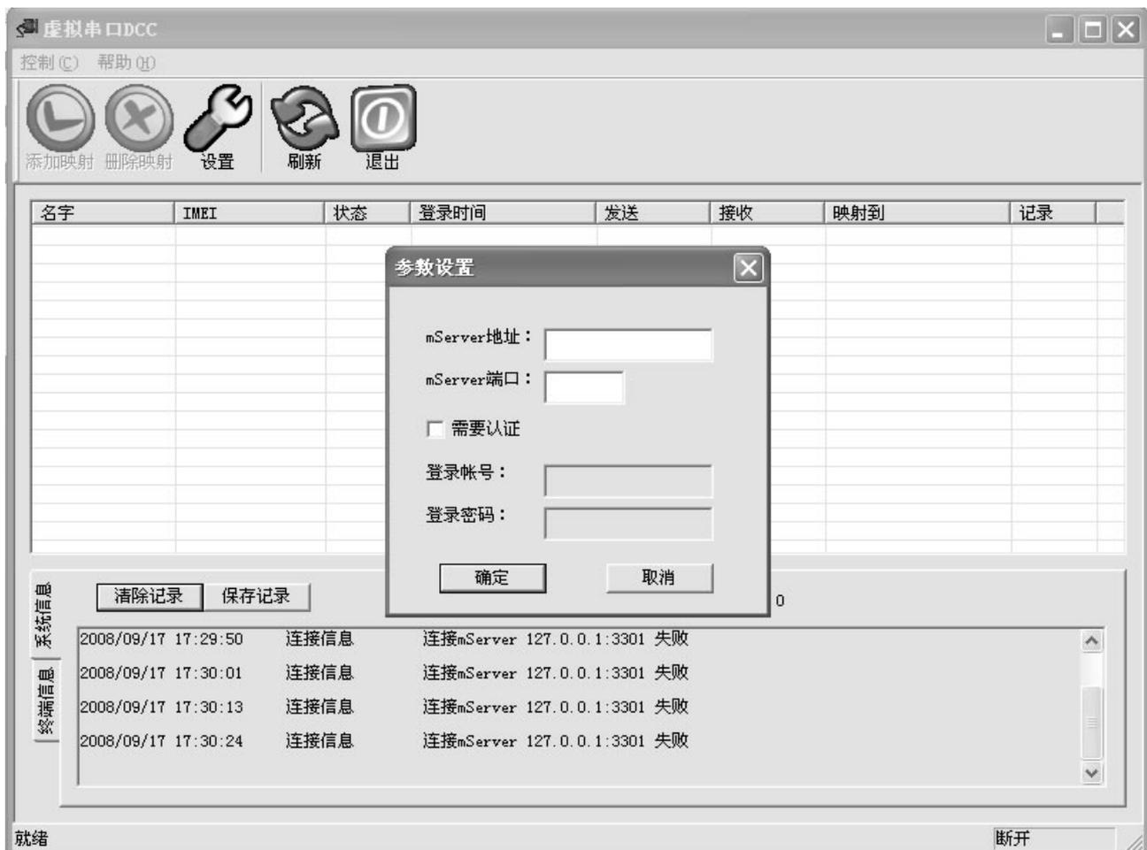
**步骤 4.** 在“mServer 地址”中输入可以访问到 mServer 的 IP 或域名，例如本例中的数据中心 IP：124.42.63.3；根据 mServer 端所做的设置，在“mServer 端口”中输入可以连接到 mServer 监听 DCC 连接所用端口的端口号，本例中为“9001”，因为 mServer 端并未设置身份证，其余保持默认（关于 mServer 监听端口设置，详见“配置 MD69G 连接到 mServer”），然后点击确定。
